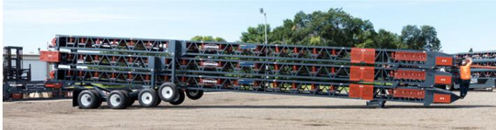
3 TRANSPORTADORES DE TRANSFERENCIA EN UNA SIMPLE CARGA
