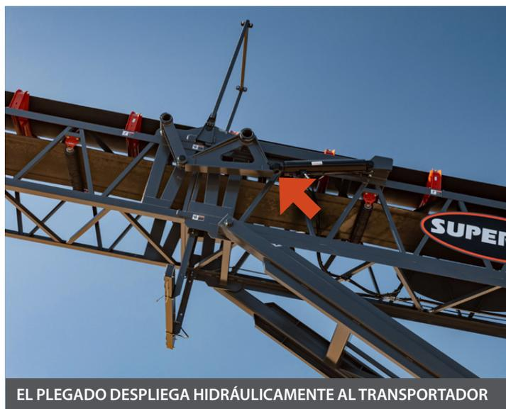
EL PLEGADO DESPLIEGA HIDRÁULICAMENTE AL TRANSPORTADOR
