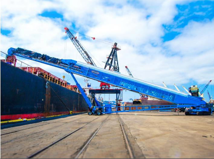
**ALTURA VARIABLE SE AJUSTA A LA EMBARCACIÓN**
